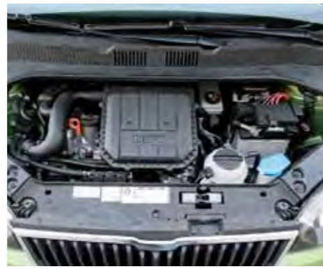
Jediný rozdíl pod kapotou najdeme před krytem motoru. Litrový tříválec s výkonem 44 kW totiž dostal navíc systém sekvenčního vstřikování plynu.
