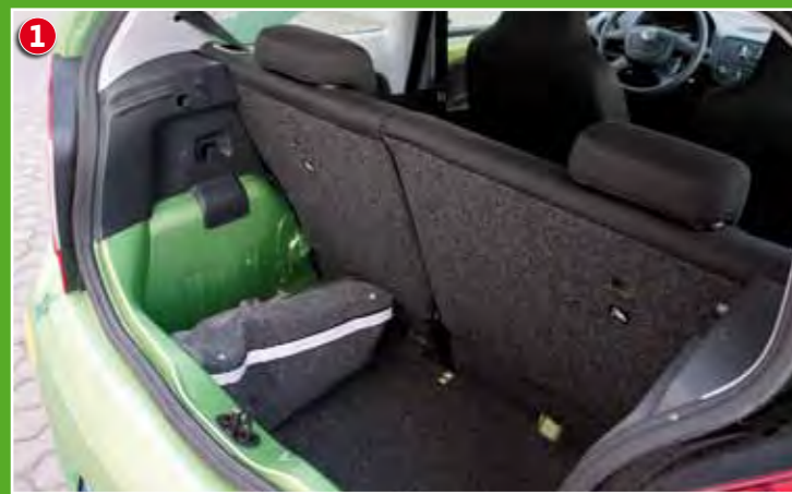
1 Velikost kufru se přestavbou na pohon LPG nezměnila. Běžné citigo s rezervním kolem má také objem 234 l. 2 V případě testovaného vozu ale byla pod jeho podlahou umístěna nádrž na 30 l LPG. 3 Redukce s keramickým filtrem se našroubuje do závitů vedle hrdla benzinové nádrže. 4 Povinná výbava a sada na rychlou opravu pneumatik skončily v tašce.
