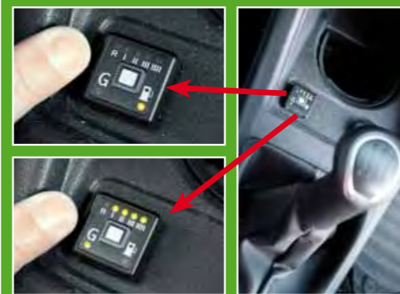
Přepínač paliva je před řadičkou. Když svítí oranžová dioda vpravo, jede se na benzin, zelené znamenají provoz na LPG.
