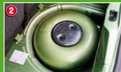
1 Velikost kufru se přestavbou na pohon LPG nezměnila. Běžné citigo s rezervním kolem má také objem 234 l. 2 V případě testovaného vozu ale byla pod jeho podlahou umístěna nádrž na 30 l LPG. 3 Redukce s keramickým filtrem se našroubuje do závitů vedle hrdla benzinové nádrže. 4 Povinná výbava a sada na rychlou opravu pneumatik skončily v tašce.
