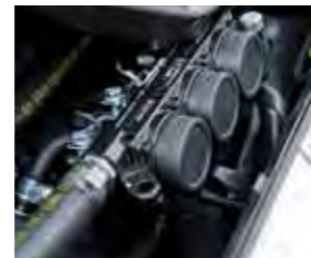
Jediný rozdíl pod kapotou najdeme před krytem motoru. Litrový tříválec s výkonem 44 kW totiž dostal navíc systém sekvenčního vstřikování plynu.
